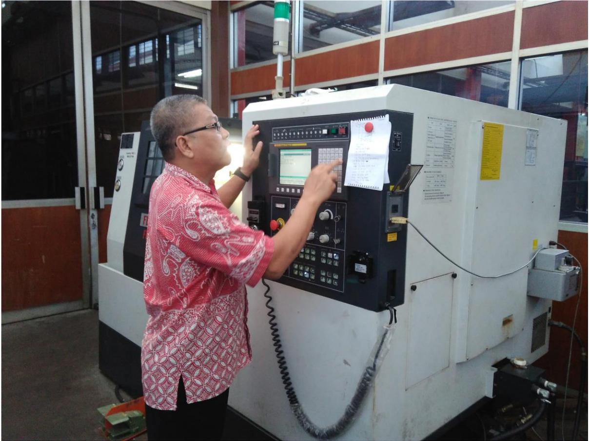
Gambar 4. Menulis program CNC di Mesin bubut CNC
